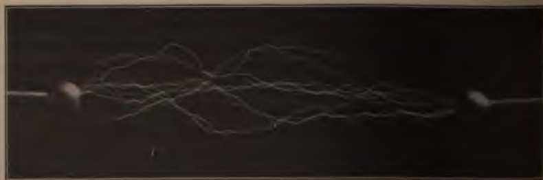
Abb. 279. Aktive Funkenentladung eines Transformators.
